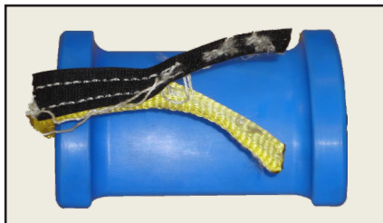
Correas de retención dañadas Si faltan correas de retención, están dañadas o no funcionan, retirelas del servicio.
