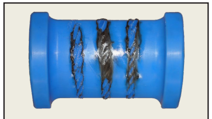
Daños estructurales Si los protectores de esquina magnéticos están dañados, retirelos del servicio.
