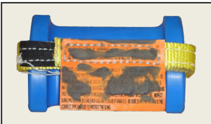
Etiqueta dañada, faltante o ilegible La etiqueta debe incluir: nombre o marca comercial del fabricante, número de inventario, capacidad de protección e información de uso/seguridad.
