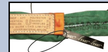
FALTA EL EWI
