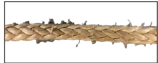
Rotura de fibra
