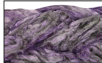
Abrasión externa excesiva
