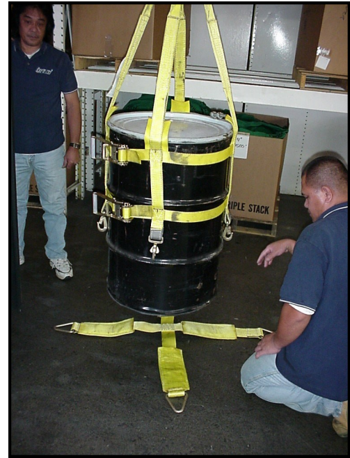
Step 2: Levante el tambor lo suficiente como para pasar el soporte del fondo por abajo del mismo.
