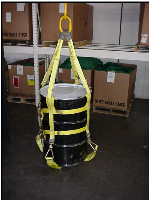
Step 3: Coloque el tambor en la brida de soporte del fondo y únala a los ganchos del ensamble.
