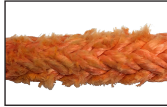
Abrasión externa excesiva
