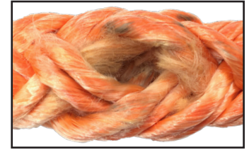
Abrasión interna excesiva
