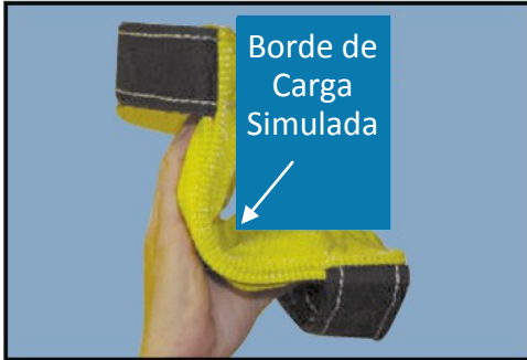
SE FORMA UN TÚNEL O "ZONA SIN CONTACTO" SE FORMA ENTRE LA ALMOHADILLA Y LA ESQUINA.
