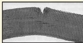
Cortes o roturas
